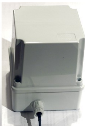
anténa FA1 v krytu IP56 pro venkovní prostředí, uvnitř krabice je anténa FA1 na otočném držáku
